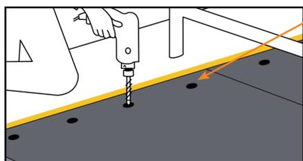
Am vorderen Rand 4 x durch die vorgefertigten Befestigungspunkte befestigen
