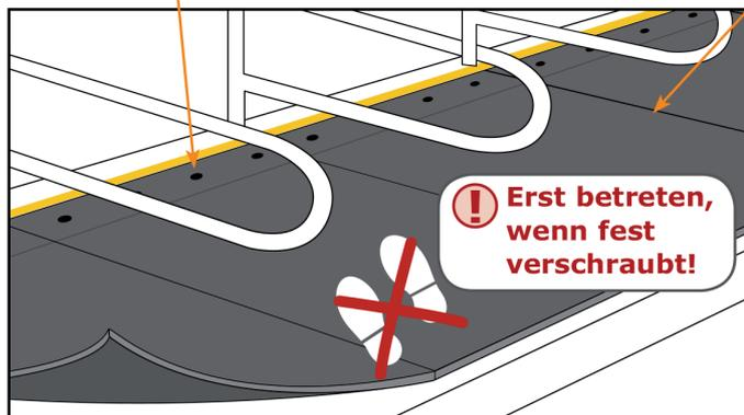
Puzzerverbindung bzw. Stoß in etwa unter dem Trennbügel (max. +/- 8 cm)
