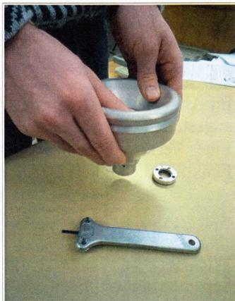
Nachdem Sie den Separator geöffnet haben, die Scheide abnehmen und die Teller ohne Gewalt entfernen.
