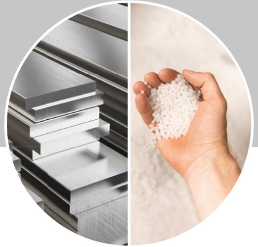
**Der Einsatzzweck entscheidet: Für die Lagerung größerer Mengen oder den Einsatz auf Baustellen, ist robuster und langlebiger Stahl der geeignete Werkstoff. Für leichtes Handling und flexible Mobilität ist PE durch sein geringes Eigengewicht die erste Wahl.**
